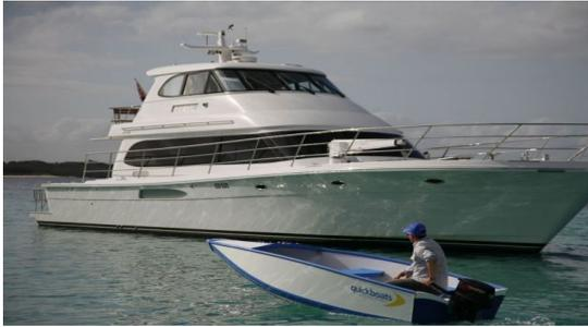
目前Quickboat售价为2850英镑（约2.65万人民币）。这家澳大利亚公司表示，如果船只以低于5HP马力行驶，那么将减少注册费。船体结构的设计者表示Quickboat非常的安全，因为它利用了高级的复合材料，例如高端的玻璃纤维和凯芙拉纤维（美国杜邦公司研制的一种芳纶纤维材料产品的品牌），能够像其他传统小型船只一样正常运行。（来源www.dailymail.co.uk）
